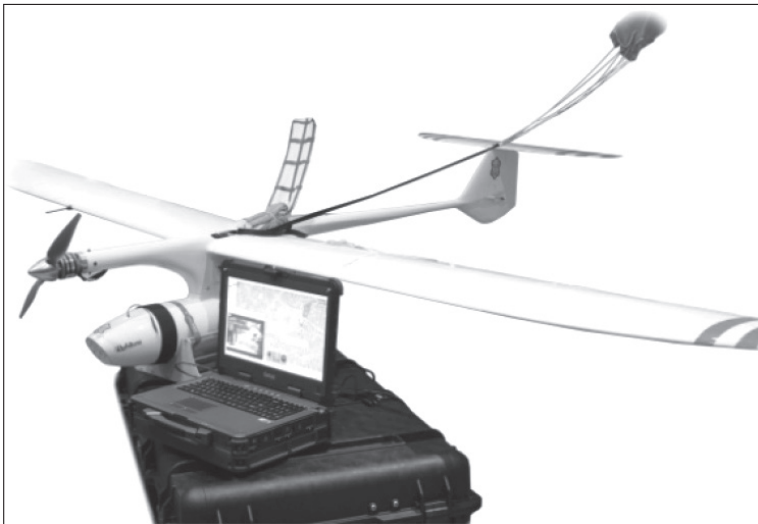
Rys. 5. Elementy systemu: minisamolot z głowicą i spadochronowym układem odzyskiwania, panel operatorski NSKL, kontener transportowy
