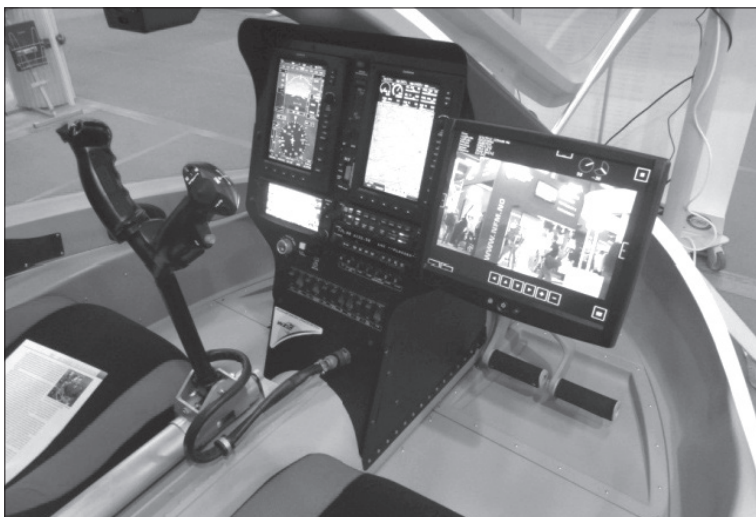
Rys. 4. Widok wnętrza kabiny samolotu OSA z terminalem systemu monitorowania i nadzoru
